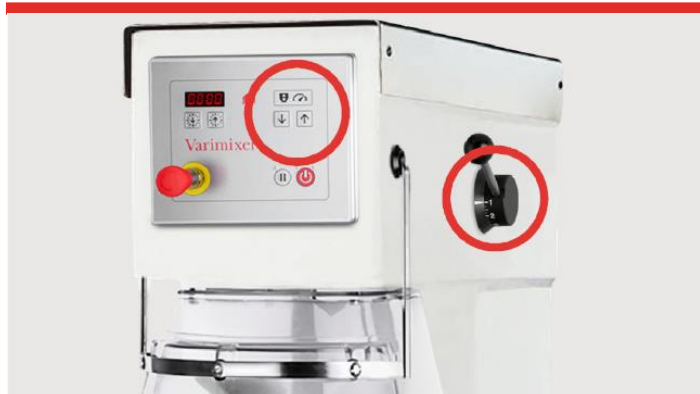
VL1L – Régulation de la vitesse manuelle et abaissement automatique de la cuve
