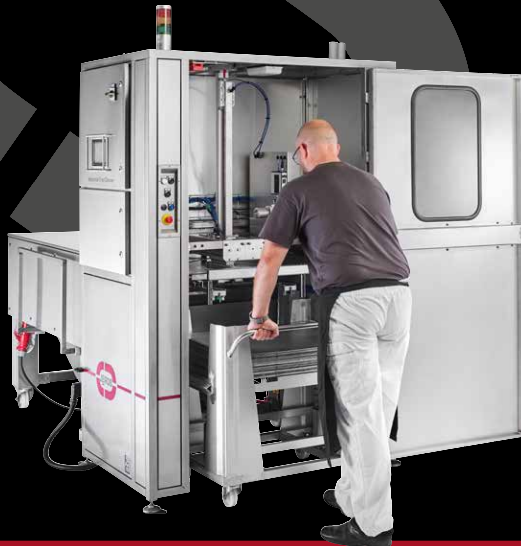
Un système d’aspiration pneumatique soulève la plaque du chariot vers le système de nettoyage.
