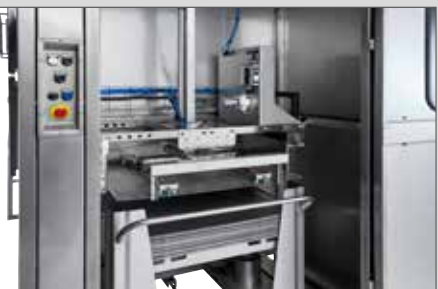
Un système d’aspiration pneumatique soulève la plaque du chariot vers le système de nettoyage.
